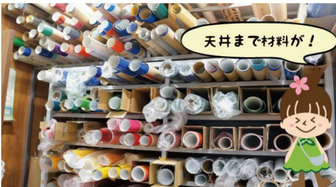
獅以前は、看板と言えば、カッティングシートに写した文字やイラストを、一つ一つカッターで切り抜き、手作業でアクリル板や横断幕などに貼って作るのが主流だったのが、現在はカッティングマシンでスピーディに切り抜いたり、直接幕に印刷できるようになったそう。
